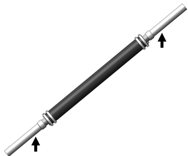
Figur 6. Rörledningsstöd i en vinklad installation.
